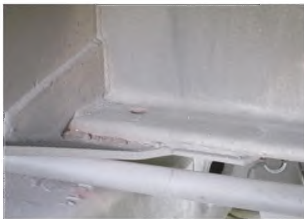
Рисунок А.27 – Відсутність заклепки кріплення п'ятника до рами вагона
