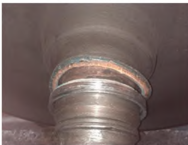
Рисунок А.13 – Злам лабіринтного кільця за всім діаметром на дві частини
