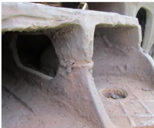
Рисунок А.31 – Тріщина надресорної балки
