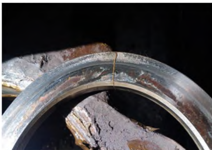
Рисунок А.12 – Злам плоско-упорного кільця внаслідок порушення технології ремонту
