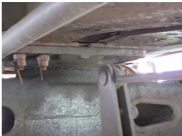
Рисунок А.28 – Відсутність 2 болтів кріплення п'ятника до рами вагона
