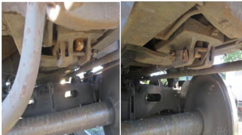
Рисунок А.20 – Випадання клина тягового хому́та автозчепу вагона через відсутність спеціальної підтримуючої планки та зламу кріпильного болта
