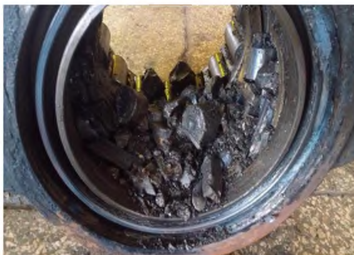
Рисунок А.9 – Руйнування підшипника буксового вузла через неякісне виконання ремонту
