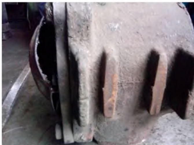
Рисунок А.16 – Пошкодження оглядової кришки буксового вузла
