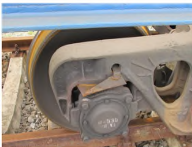
Рисунок А.30 – Злам накладки буксового прорізу
