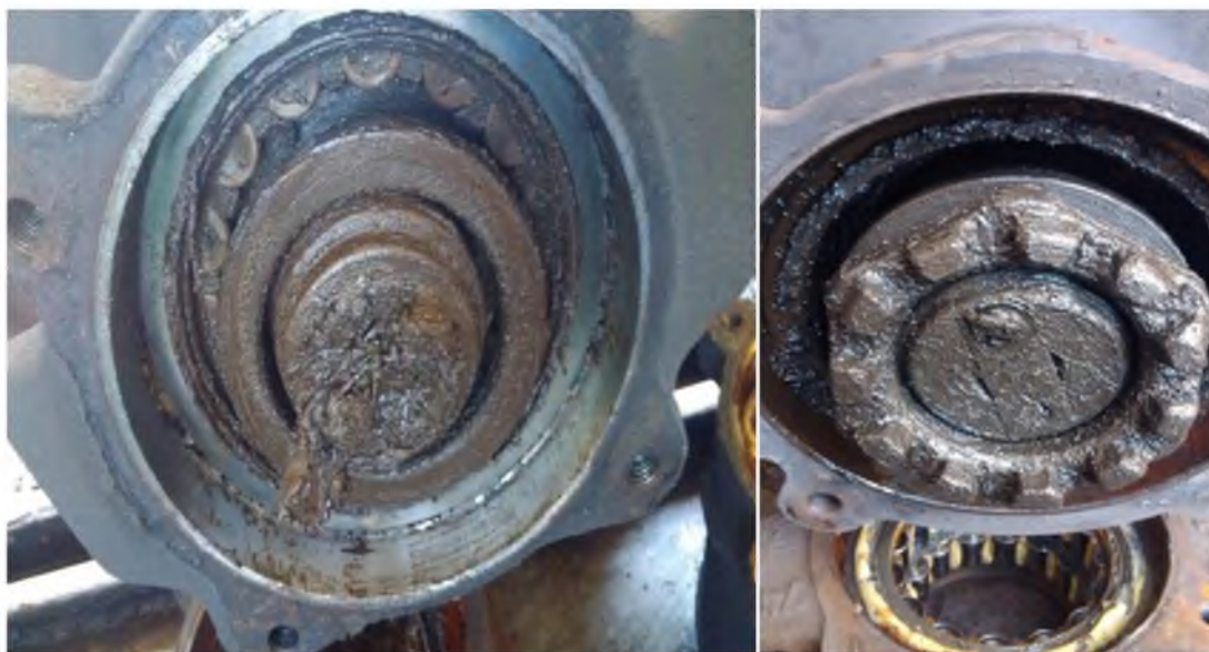
Рисунок А.11 – Порушення технології торцевого кріплення гайки М110
